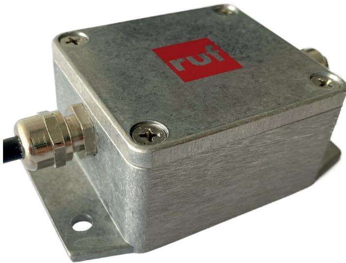
Der VisiWeb Mikrofonverstärker DMPE ist ein kompakter Vorverstärker für dynamische Mikrofone. Aufgrund seiner Robustheit und der IP67-Zertifizierung eignet er sich besonders für die Verwendung im Bahnbereich.
