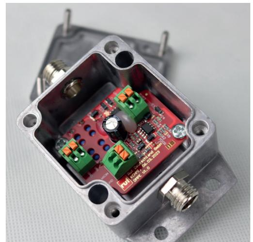
Die Elektronik im DMPE ist staub- und wassergeschützt im robusten Metallgehäuse untergebracht.
